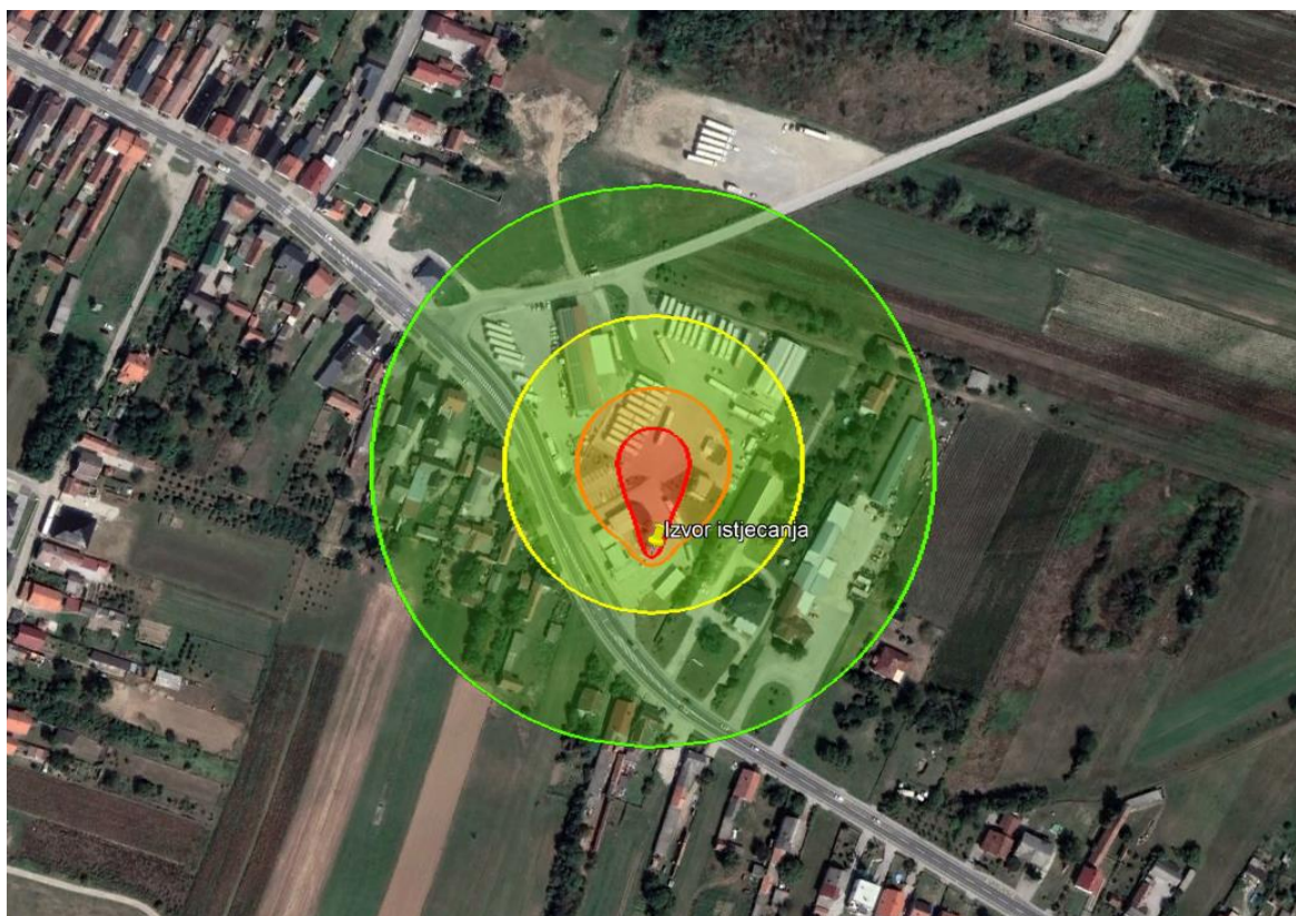
Slika 16. Zone ugroženosti uslijed eksplozije plinske faze benzina
