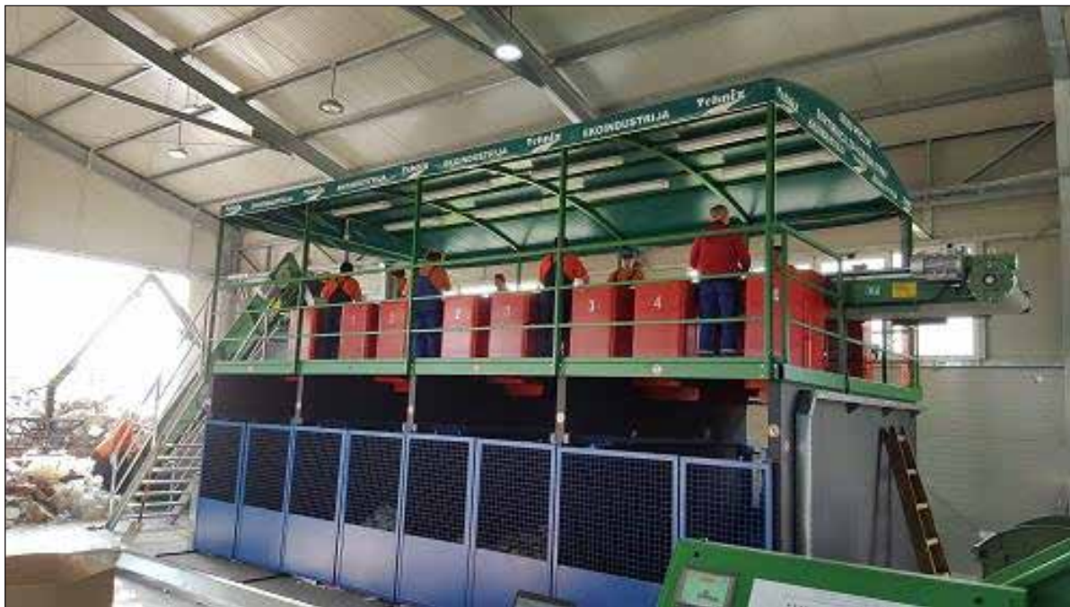
Slika 6. Traka za ručno sortiranje otpada
