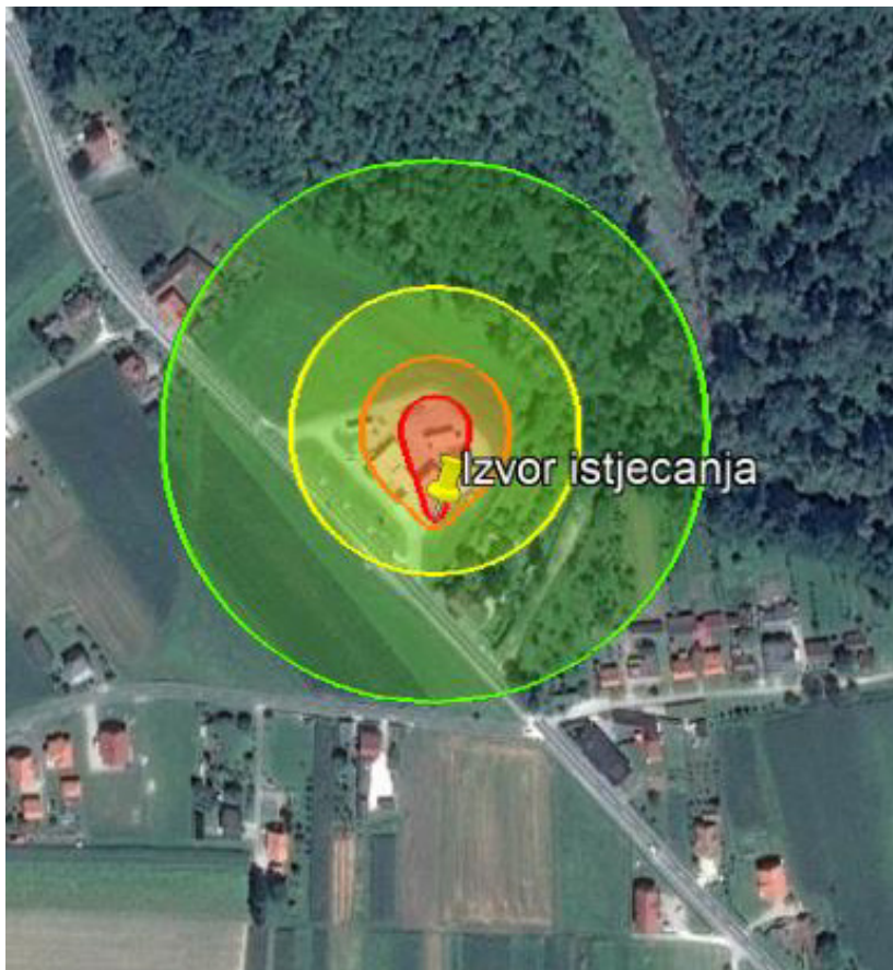
Slika 19. Zone ugroženosti uslijed eksplozije plinske faze benzina
