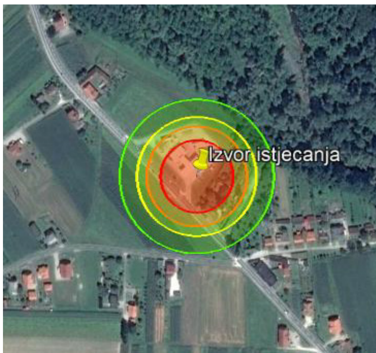
Slika 20. Zone ugroženosti uslijed istjecanja cjelokupne količine benzina i nastanak požara
