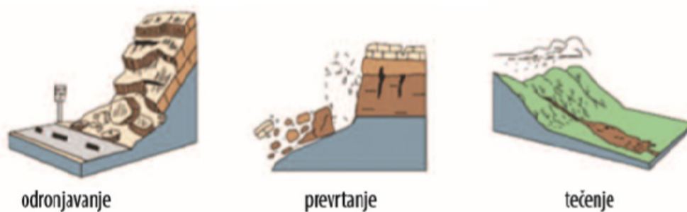
Slika 19: Prikaz osnovnih tipova klizanja prema mehanizmu kretanja
